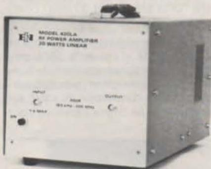
Le temps de réponse est extrêmement bref étant donné que les temps de montée et de descente sont de l'ordre de 2 à 3 nanosecondes. Cet amplificateur peut fonctionner en permanence sur n'importe quelle impédance, du court-circuit au circuit ouvert.
