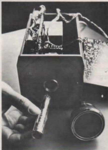
l'oxyde de plomb ou bien des multidoxydes au silicium. Siemens lance sur le marché une nouvelle génération de vidicons, dans ces mêmes diamètres (XQ 1450 à 1480) dont la couche photosensible est en sélénure de cadmium. Les sensibilités spectrale et absolue sont considérablement améliorées, ainsi que le gamme, le courant d'obscurité, le traînage et le pouvoir séparateur. Les modèles au sélénure de cadmium peuvent remplacer, sans
