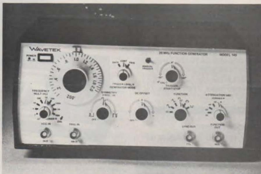
TEK 143 va de 1 milliHertz à 20 mégahertz. La tension de sortie maximale est de 30 volts crête à crête ou 15 volts dans 50 ohms. Un atténuateur par bonds de 20 dB avec vernier permet d'obtenir un signal propre et exempt de bruit jusqu'à 80 dB au-dessous du niveau maximal.
