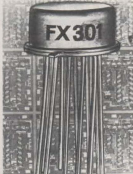
Le FX 301 L se présente en boîtier métallique genre TO5 à 10 broches. Il est protégé de façon interne contre les décharges statiques.
