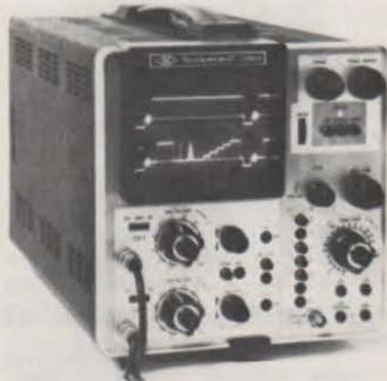
d'entrée assure une dérive minimale, une stabilisation rapide et une grande fiabilité. Pour faciliter la maintenance, les transistors sont enfichés dans des supports.
