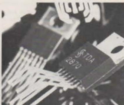
les pannes provoquées par un mauvais traitement (lors du montage ou d'une réparation). La résistance thermique maximale s'élève à 5°C/W (boîtier du chip).
