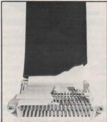
assurer une fiabilité électrique maximum. Pour l'installer, il suffit de positionner le câble dans l'ouverture du connecteur et de serrer. Il est possible de raccorder jusqu'à 37 conducteurs simultanément sans dénudage du fil ni soudure.
