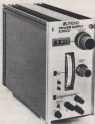
La commande numérique "Oltronix" permet un ajustage précis et une lecture aisée.
